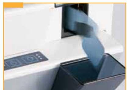
■ Gelöschte Speicherfolien, die zur Wiederverwendung bereit sind, werden in das Plattenfach ausgeworfen.
