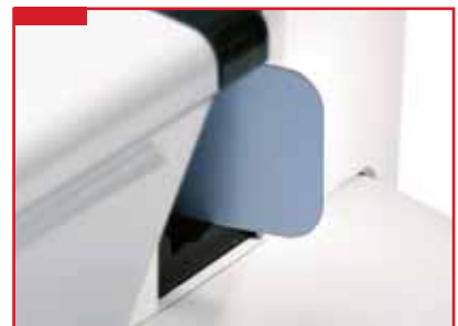
■ Die Größe der Speicherfolien wird automatisch erkannt.
